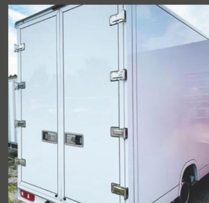
✓ Mit 4 Schanieren verstärkte Hecktüren für mehr Stabilität
