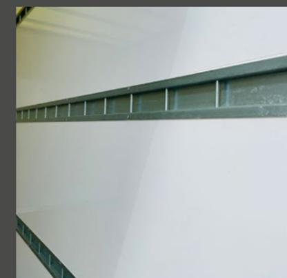
✓ In den Seitenwänden versenkte Stab-Zurrleisten für einfache Ladungssicherung
