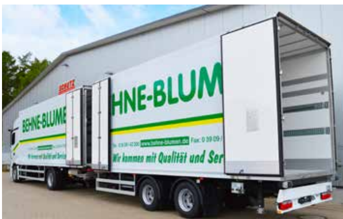
LKW-Zug für 48 (26+22) CC-Container und Durchladesystem.
