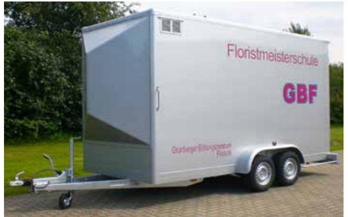
Kofferranhänger Typ TK 30 D für 9 CC mit GFK-Aerovorbau.
