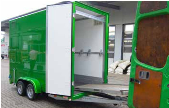
Kofferranhänger Typ TK 27 D für 7 CC mit Durchladesystem.
