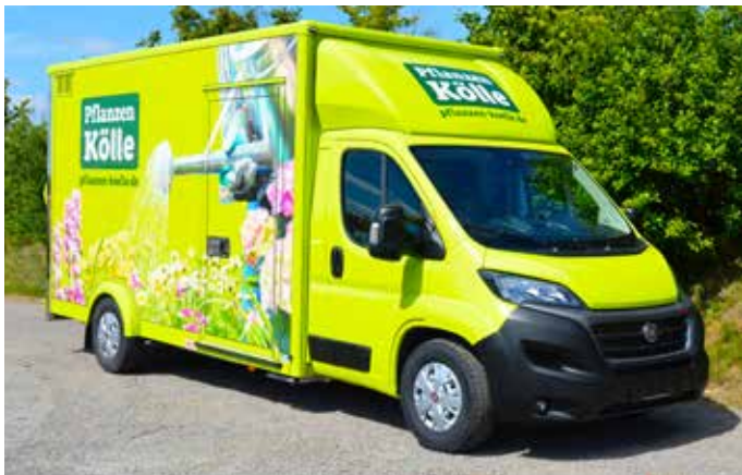
Tiefrahmenkoffer für 9 CC-Container mit 3.500 kg zGG.
