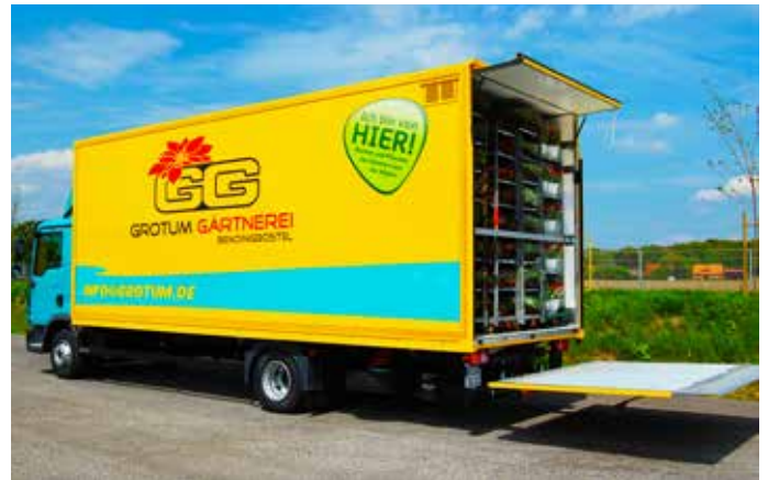
Schutz Blumenkoffer für 20 CC-Container mit Laderaumheizung.
