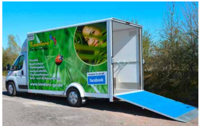
Isolierter Kofferaufbau mit leichtgängiger Auffahrrampe.
