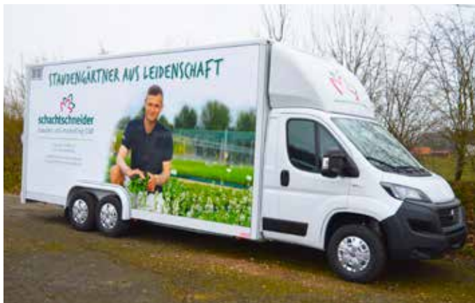
Tiefrahmenkoffer für 12 CC-Container mit 5.500 kg zGG.
