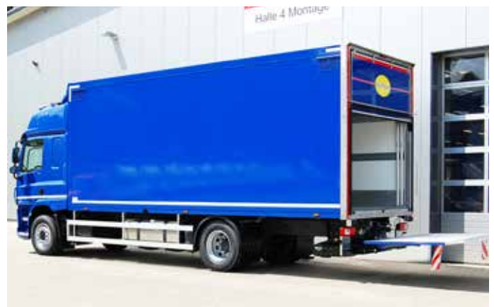
Schutz Kofferaufbau für 22 CC-Container auf 18 t. Fahrgestell.
