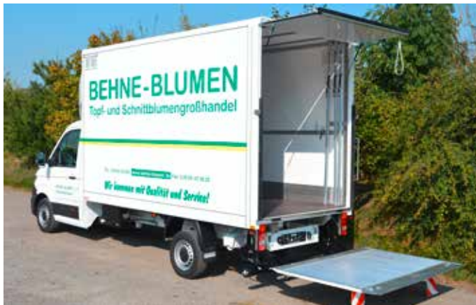
Schutz Blumenkoffer 9 CC mit Heizung und 750 kg LBW.
