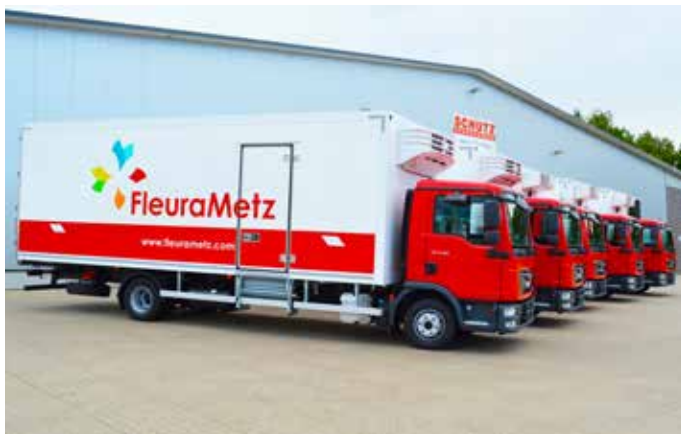
Tourenfahrzeuge mit Seitentür und Kühlmaschine.
