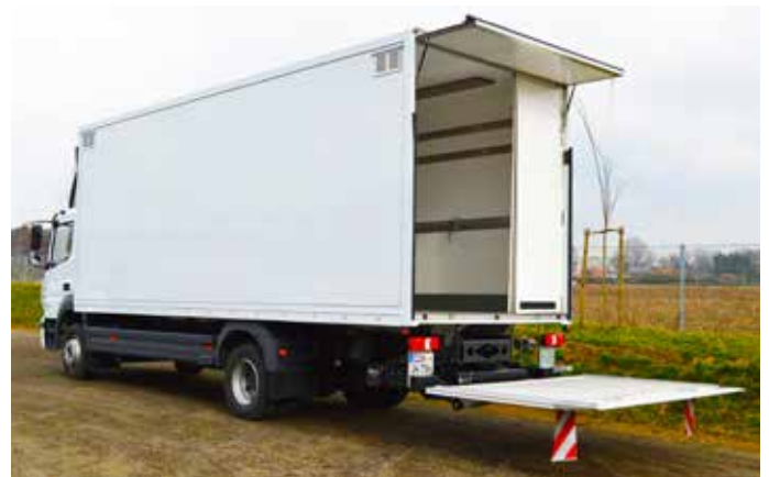
1500 kg Ladebordwand und 3-teiliger Isoliervorhang.
