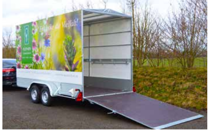
Planenanhänger Typ GTA 35 D für 9 CC-Container.
